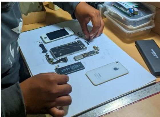
**Gambar 6.** Penentuan layout dari bagian ponsel Iphone 4 yang telah dibongkar untuk pembuatan sketsa dasar
