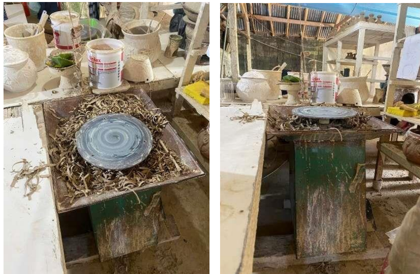
Gambar 8: Meja Putar Untuk Membentuk Keramik pada Perusahaan Tri Surya Keramik (Sumber: Dok. Ismayana Tj., 2021)
