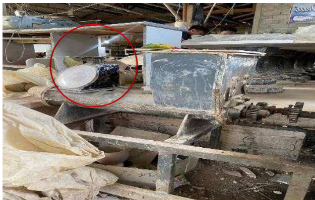
Gambar 5: Alat Timbang Tanah Jenis Duduk di Tri Surya Keramik (Sumber: Dok. Ismayana Tj., 2021)
