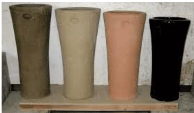
Gambar 2: Perubahan Fisik yang Terjadi Karena Pembakaran (Sumber: Dok. Ismayana Tj., 2021)
