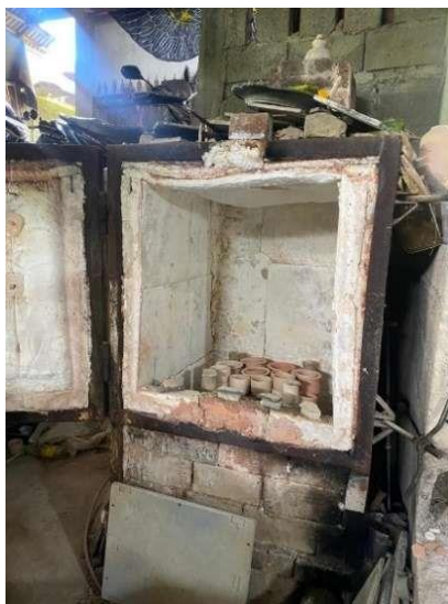
Gambar 9: Tungku Bakar pada Perusahaan Tri Surya Keramik (Sumber: Dok. Ismayana Tj., 2021)
