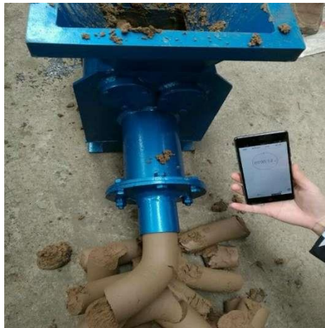
Gambar 7: Alat Penggilingan Tanah pada Perusahaan Tri Surya Keramik (Sumber: Dok. Ismayana Tj., 2021)
