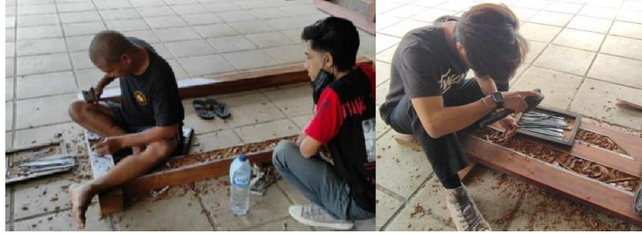
Gambar 6. Proses Pengukiran Pada Kusen dan Daun Pintu ( Sumber : Maha Diadnyana, 2021 )
