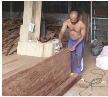
Gambar 3. Proses Penyerutan Kayu
