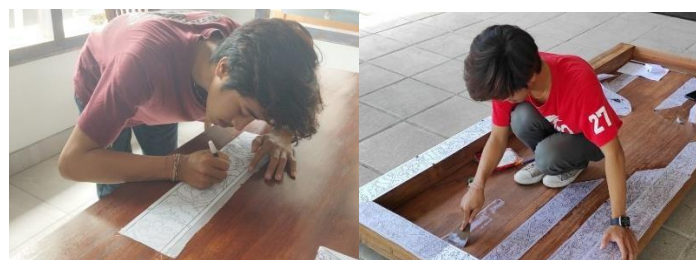
Gambar 5. Proses Pembuatan Mal dan Penempelan Mal Ukiran Pada Pintu Kuwadi
