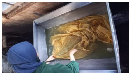
Gambar 9. Proses Fiksasi dengan tawas Dokumentasi oleh : Gede Tasih,2021 Lokasi : CV.Tarum Bali Sejahtera
