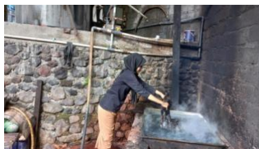
Gambar 19. Proses Pelorodan Dokumentasi oleh : Okta,2022 Lokasi : CV.Tarum Bali Sejahtera
