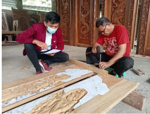
**Gambar 7:** Pembuatan Konstruksi *Purus* Pada Daun Pintu Kuwadi.
