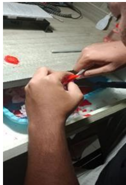
Gambar 21. Proses pemotongan suport Dokumentasi oleh : Yudhi,2021 Lokasi : UD. Romo
