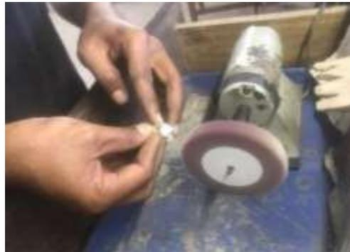
Gambar 9. Pengamplasan menggunakan dinamo
