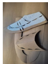
Gambar 17. Memotong Pola Sepatu (Sumber:Qhawa Rosha Tamara, 2023)
