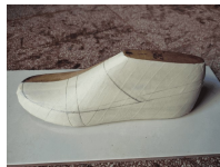
Gambar 14. Menggambar Pola pada Cetakan (Sumber:Qhawa Rosha Tamara, 2023)
