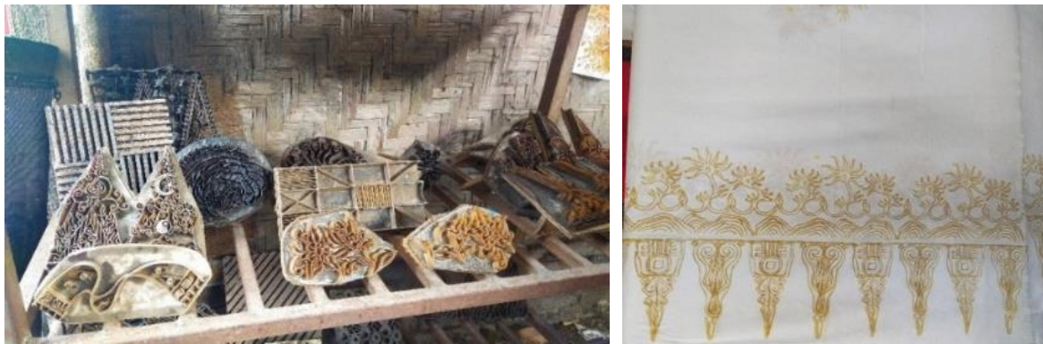
Gambar 1. Alat Cap Batik Milik Nurohmad dan Contoh Kain yang Sudah Dicap (Sumber: Nur Annisa Intania, 2023)
