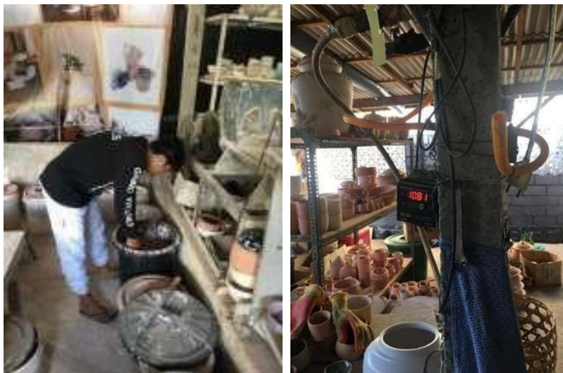
Gambar 4: Proses Pengglasiran Produk tahap 2 dan proses pembakaran (Sumber: Dewa Gede Wiswambhara, 2023)
