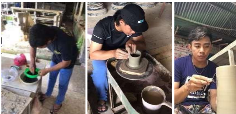
Gambar 2: Proses pencampuran bahan, pembentukan, dan pengvetriman body keramik (Sumber: Dewa Gede Wiswambhara, 2023)
