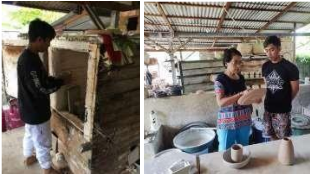
Gambar 3: Proses penyusunan bkeramik pada tungku bakar dan pemeriksaan keramik setelah dibakar Biskuit (Sumber: Dewa Gede Wiswambhara, 2023)
