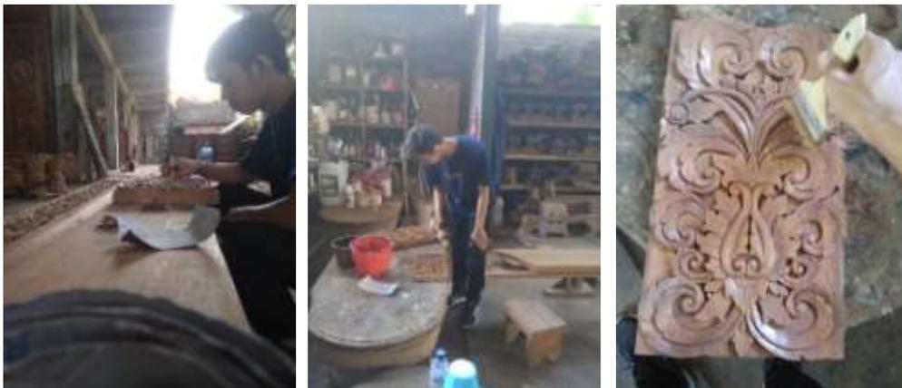
**Gambar 9, 10, & 11:** Proses Pengampelasan, Proses Pelapisan Sanding Seler, dan Proses Pelapisan Clear
