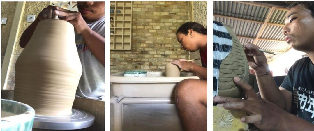
Gambar 9. Proses pengetriman body keramik dan pendekorasian
