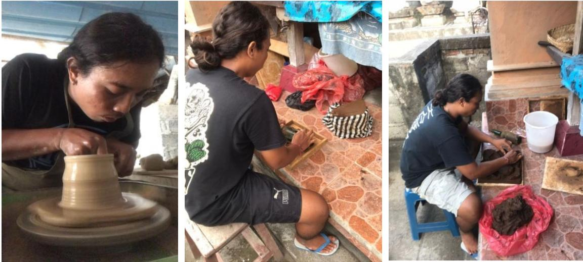
Gambar 8. Teknik Putar (*Hand well*), Teknik Lempengan (*Sleb*), dan Teknik Pijat Jari (*Pinching*)
