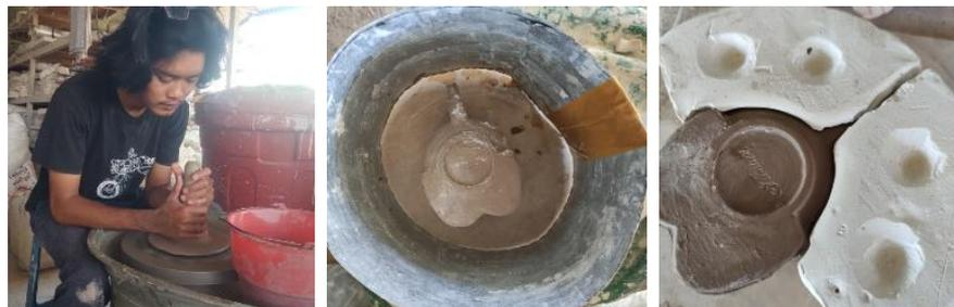
Gambar 3. Proses pembuatan model dan pembuatan cetakan negatif
