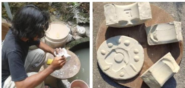
Gambar 4. Proses pembersihan cetakan negatif
