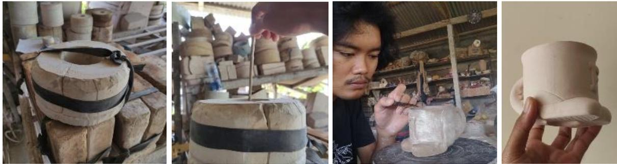
Gambar 5. Proses pencetakan negative (model) dan model yang sudah dibakar biscuit
