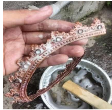
Gambar 30: Proses Pencucian Dengan Air Aki (Sumber: Sukajaya, 2024)
