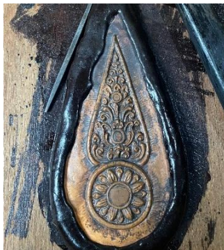
Gambar 12. Proses nyawawi dan megatan (Sumber : Raditya, 2025)
