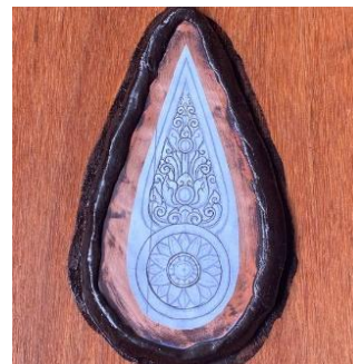
Gambar 9. Proses pembakaran tembaga dan penempelan desain (Sumber : Raditya, 2025)
