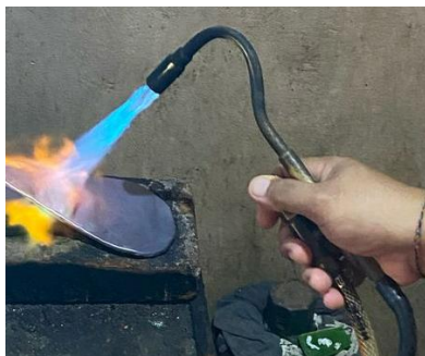
Gambar 9. Proses pembakaran tembaga dan penempelan desain (Sumber : Raditya, 2025)
