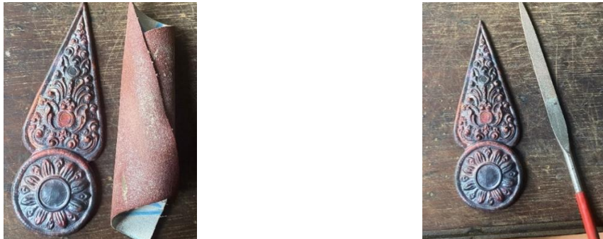
Gambar 13. Proses pengamplasan dan ngikir (Sumber : Raditya, 2025)
