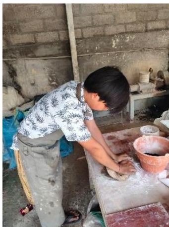
Gambar 3. Penguletan tanah (Sumber: dokumentasi Gunawan, 2025)
