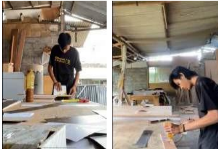
Gambar 7. Pengeleman plywood dan HPL (Sumber : Kertayasa, 2025)
