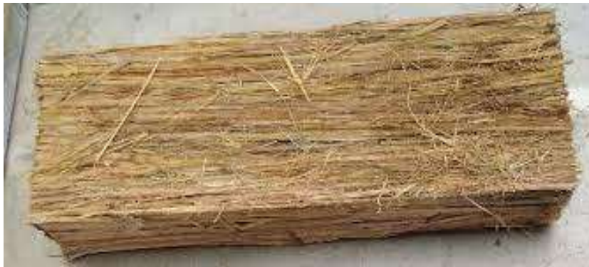
Gambar 5 : Batako dari batang jerami (Sumber : Fuadi et al., 2019 )
