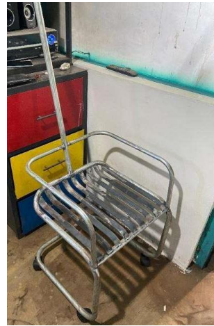
Gambar 21. Pemasangan Roda (Sumber: Dokumen Penulis, 2024)
