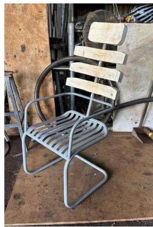
Gambar 24. Pemasangan Kayu pada Sandaran (Sumber: Dokumen Penulis, 2024)
